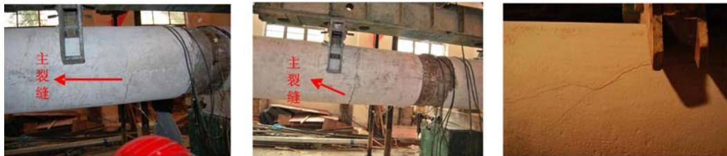
图2 试件的破坏形态
