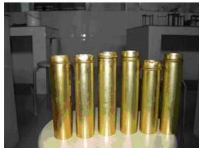
图 6 轴向载荷作用下,实验中部分试件的失稳形式
