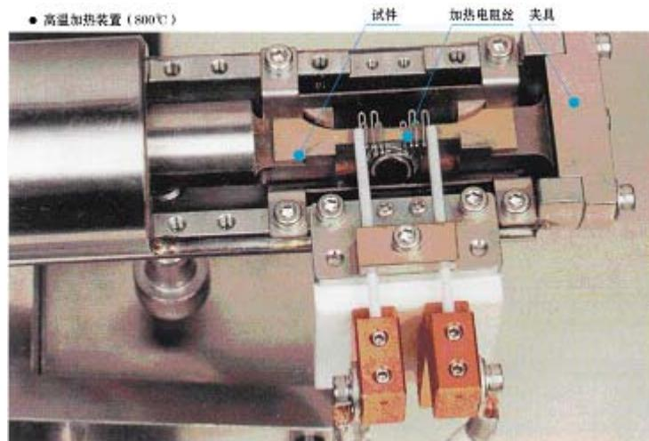
图2 SEM 高温疲劳系统温度作用下夹具图
