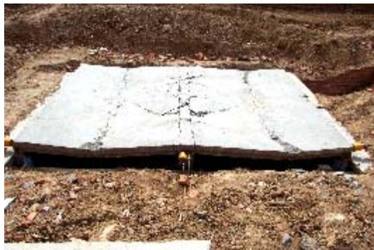
图12 顶板上表面破坏实况
