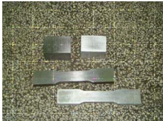
图 3 实验测试 45# 钢试样图
