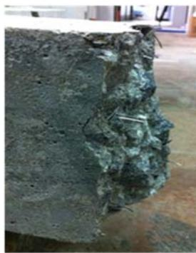
图3 未进行湿热处理的试件断口
