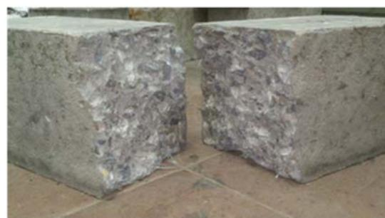
图4 经过湿热处理的试件断口
