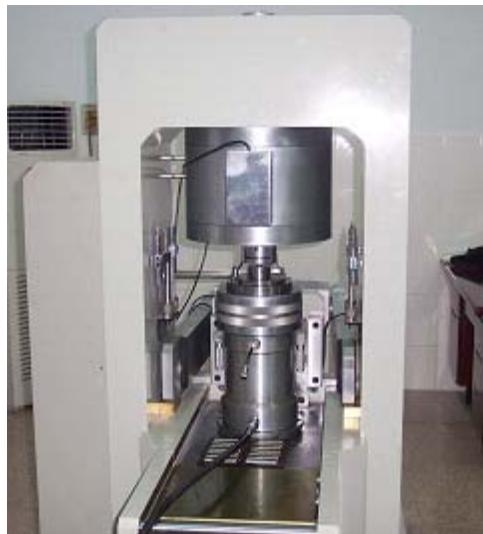
图1 RMT-150B 测试系统
