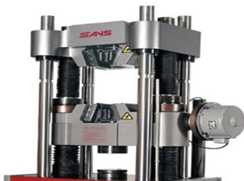
图 3 材料试验机装置
