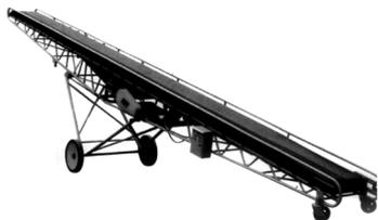
图1 皮带输送机
