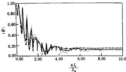
图9 四层结构改变橡胶损耗因子的反射系数频响曲线(橡胶  $c=1470 \text{ m/s}$ ;  $\rho=1039 \text{ kg/m}^3$ )
