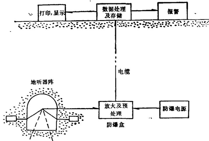
图 11 声发射监测系统框图
