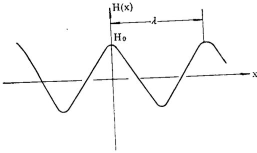
图3 沙波波形的示意图
