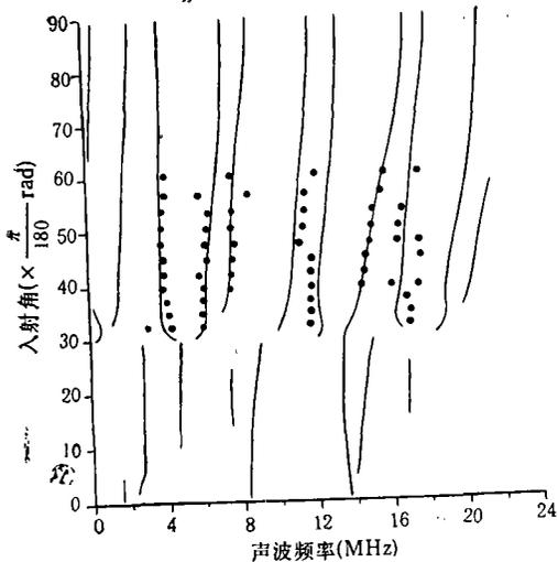
图8 弱界面时反射系数幅值  $|R_{11}|$  最小值对应的入射角和声波频率的关系(实线为理论值, 圆圈为实验值)
