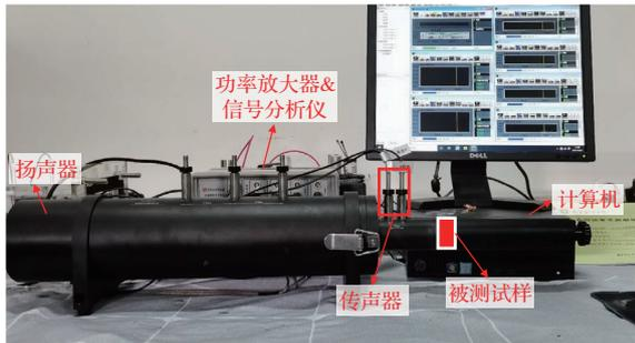
图 12 阻抗管测量系统
