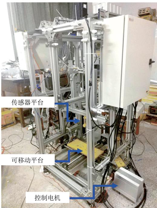
图 4 高温超导直线电机三维测试系统
