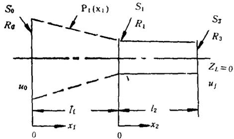
图4  $l_2$  为圆柱形复合聚能器
