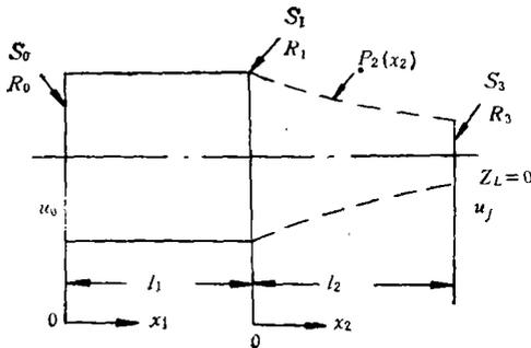
图3  $l_1$  为圆柱形复合聚能器
